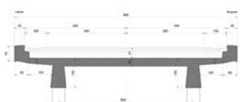
*Sezione tipo - muro di sostegno a Z*
